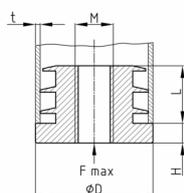
• \* ) = Die Stopfen können auch bis zu einer Wandstärke von 2 mm eingesetzt werden. Wir empfehlen, dies vor dem Einbau zu überprüfen.
